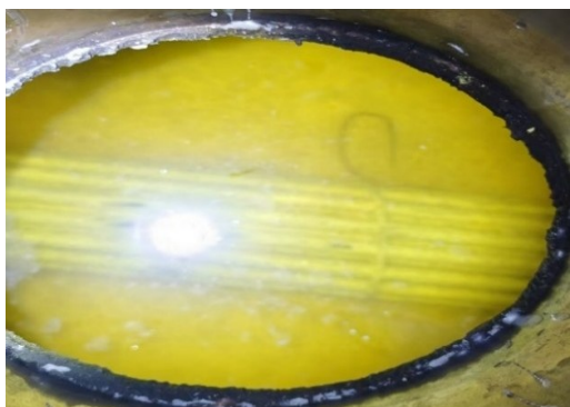
图 5 化盐罐中的熔盐凝固时的状态
