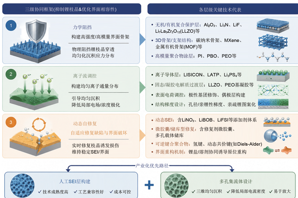
图5 锂枝晶抑制与界面相容性优化的三级协同框架与技术路线图
