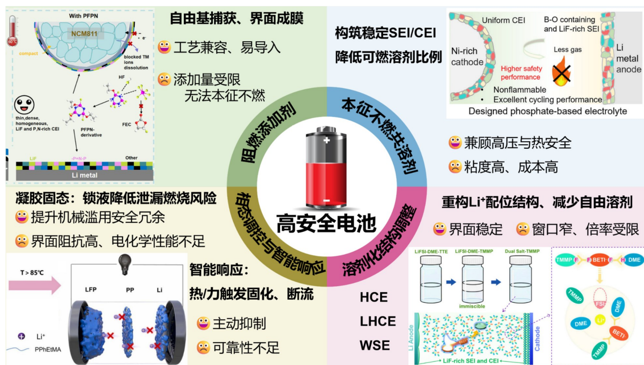
图11 面向低空飞行器动力电池的阻燃电解液设计策略、作用机制、性能优势及现阶段局限 [29, 31, 50, 58]
