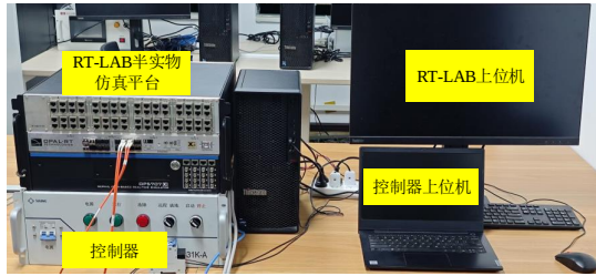
图 6 RT-Lab 半实物系统搭建图
