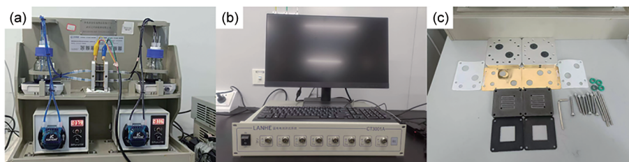
图 S7 电池性能测试系统及相关器件图: (a) 一体化液流单电池测试系统; (b) 蓝电电池监测系统; (c) 电池测试夹具
