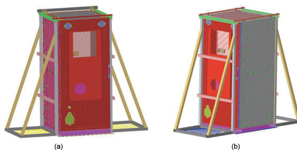
图13 电池柜有限元模型图 (a) 侧向方向; (b) 前后门方向
