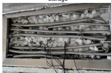
(b) 水箱蓄冷结束时相变材料状态
