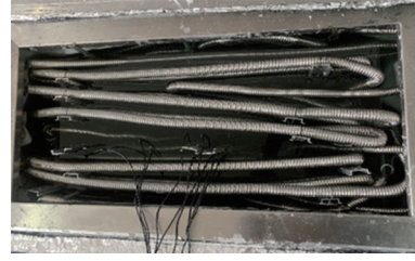
(b) 水箱蓄热完成时相变材料状态
