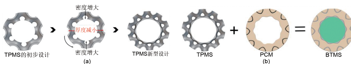
图13 变密度TPMS-BTMS结构设计: (a) 结构设计方案; (b) 系统集成方案
