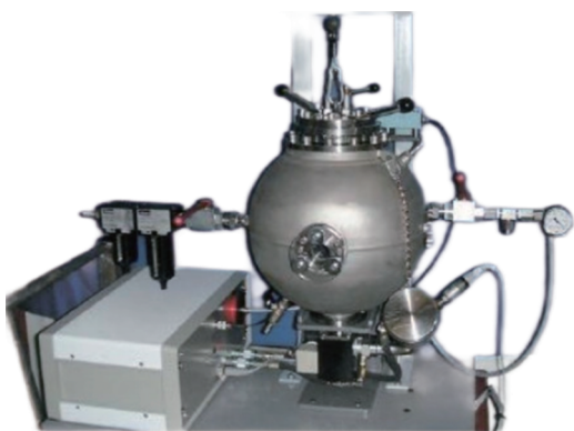
图3 20 L球气体爆炸装置 Fig. 3 20 L sphere gas explosion device
