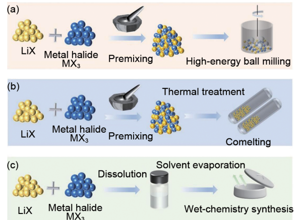
图4 金属氯化物固态电解质合成方法示意图 [30] : (a) 球磨; (b) 共融法; (c) 湿化学合成
